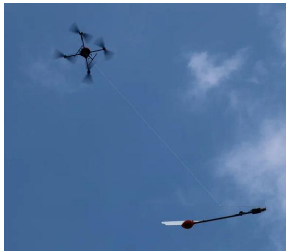
Рисунок 3.2 — Аэромагнитная установка БВС Геоскан-401
